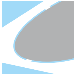
Stanzteile auf Rolle, mit Haltestegen partiell befestigt
