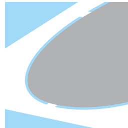
Stanzteile auf Rolle, mit Haltestegen partiell befestigt
