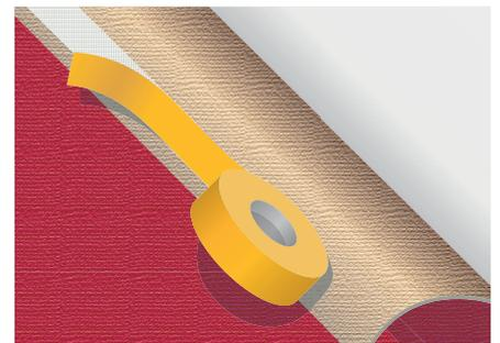
Der robuste Gewebeträger ist auf der abgedeckten Seite mit einem Synthetikgummi und auf der offenen Seite mit einem Polyacrylatklebstoff ausgerüstet. Die abgedeckte Seite ist stark klebend, die offene Seite schwach klebend.
