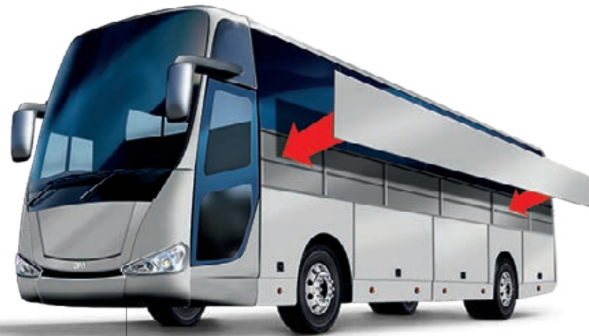
Verklebung von Karosserie-Anbauteilen
